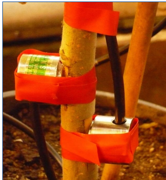
Photo 2: Mise en place de capteurs hygromètres sur le bas de tige d'un peuplier.
